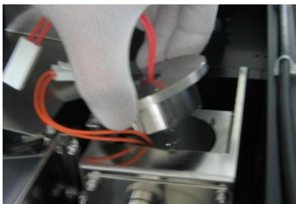
12. 从灯罩上取下lamp。Lamp有3个M3的螺丝固定。
